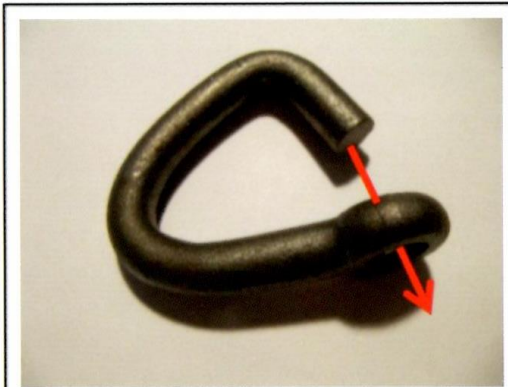
開いた状態 のコールドシャット
